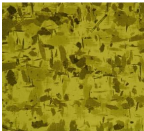
ニッケル薄膜に発生した成長粒子とEBSD解析による逆極点図
