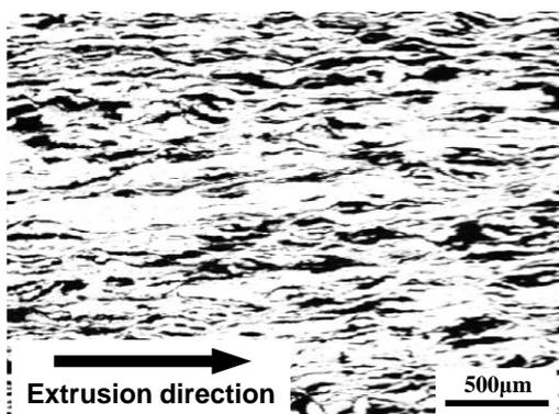
Al/黒鉛押し出し試料の縦断面の組織
