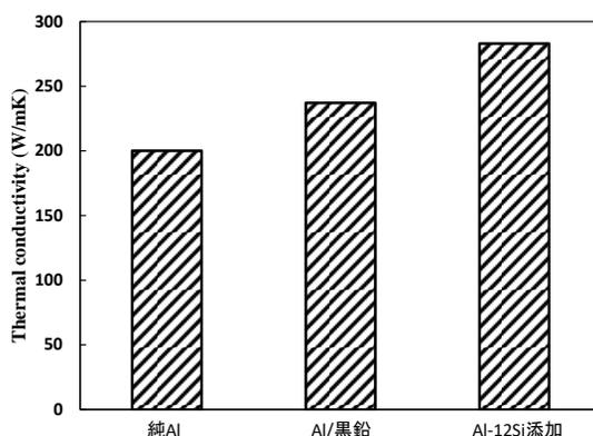
純Al押し出し材や各種Al/黒鉛押し出し試料の熱伝導率の比較
