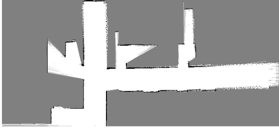
Fig.17 占有格子地図生成結果例
