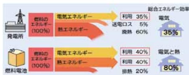
図4 発電方法とエネルギー利用効率の比較
