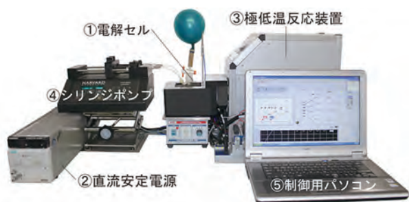
図3 液相電解自動合成装置（1号機）の外観
